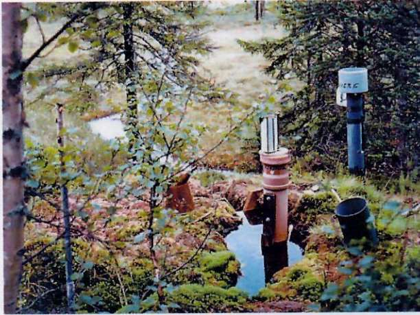
Fig. 1 Mätstation vid en av källorna i Djursvallen. Nederbörden mättes i tratten till höger om källan. Källans vattennivå registrerades genom en flottör och ett instrument i röret i källan. Vattenflödet i källan beräknades genom den relation mellan vattennivå och vattenföring, som är bestämd i det V-formade mätöverfallet i trä vid utloppet från källan. Vattenprov togs regelbundet direkt i källan. (Knutsson 1990)
