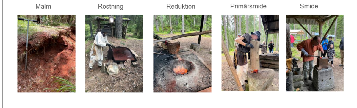
De olika processtegen vid järnframställning med blästerugn. (foton Lars O. Ericsson)
